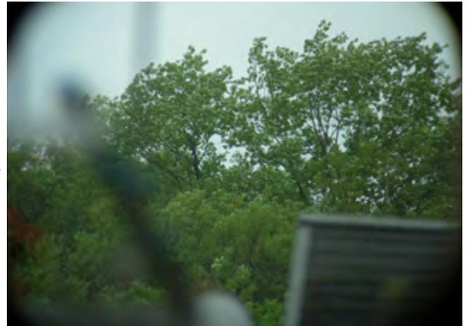
26.0 倍となり、68度の視野で開放感たっぷり。視野の端が双眼鏡側の影響でケラレが見え始めているが実害無し(写真には見えない)。メガネをかけていても視野全体が見渡せるので最高。
