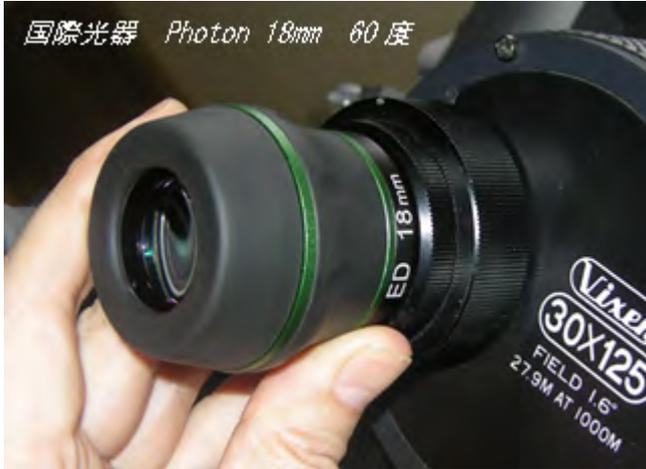
スリーブを外してピクセンのリングに載せた位置でピント。このシリーズでは25mmがあるが、その場合は25.0倍となる。
