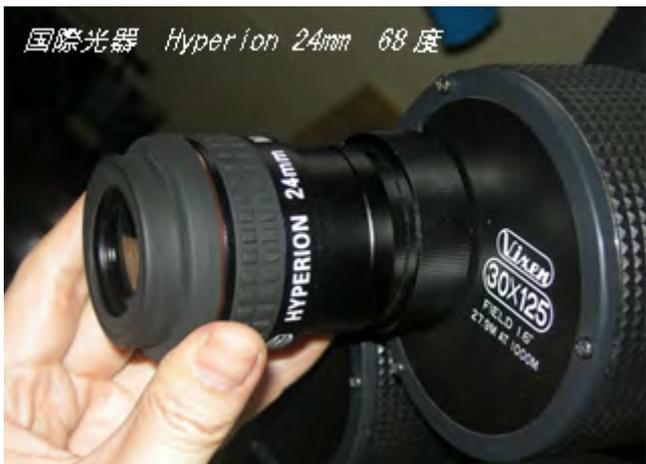
31.7 スリーブを外して、ピクセンのリングに載せた位置でピント。白い文字の下部は2inchスリーブなので、これを利用すれば調節範囲に十分余裕がある。このアイピースが理想的。
